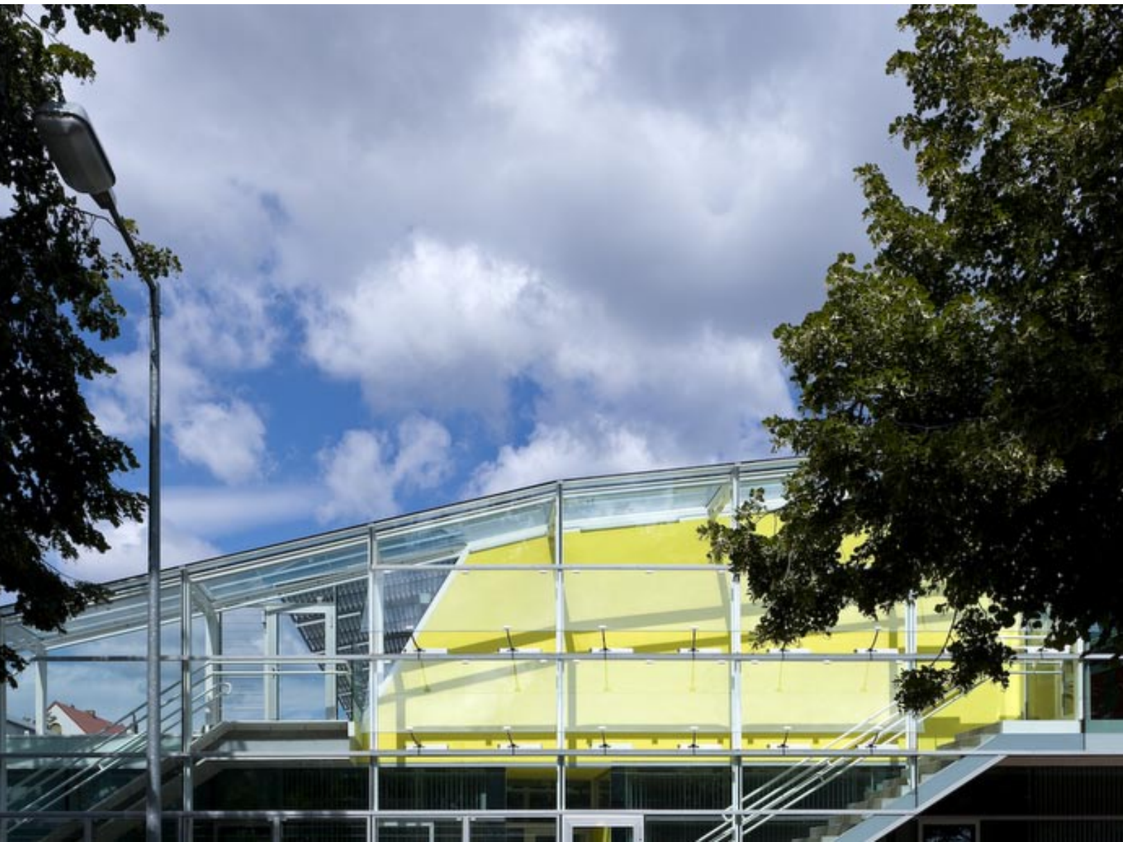
nach süden ist jedem raum ein freiraum zugeordnet. der vorgelagerte wintergarten dient als schallschutz und klimapuffer
